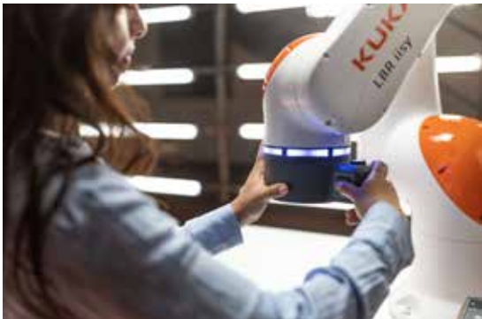
Coboten kan lära sig sina arbetsuppgifter genom enkel handstyrning.
