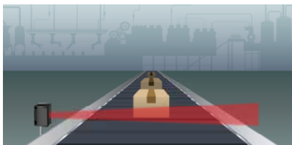
Fotocellen får inte tillbaka tillräckligt med reflekterat ljus.
