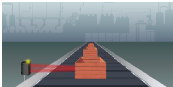
Objektet reflekterar ljus från inställt avstånd och blir detekterat. Trälådornas färgvariation påverkar inte detekteringen.
