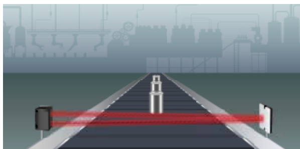
Ljuset reflekteras av en polariserad reflektor.
