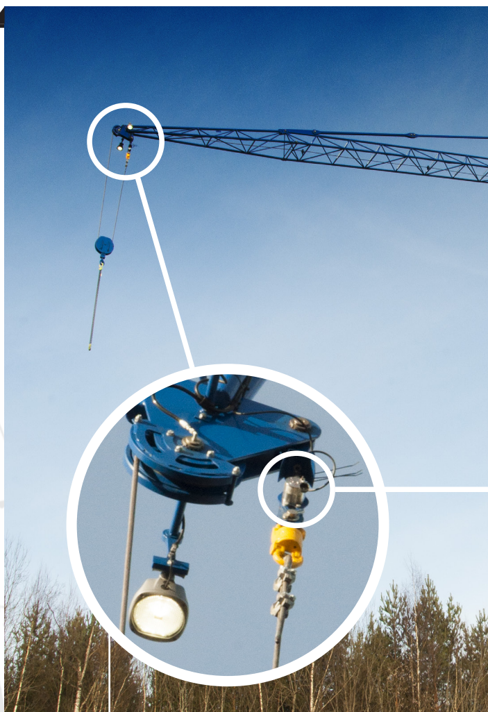
Lastcellen monterad vid kranspets för mätning av lasten.
