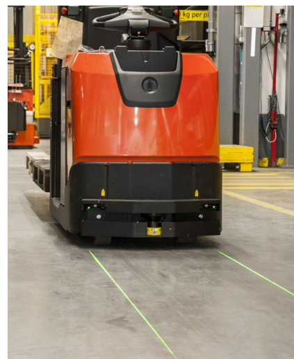
Här syns linjerna som ska hjälpa truckföraren att smidigt ställa trucken parallellt med ställagen
